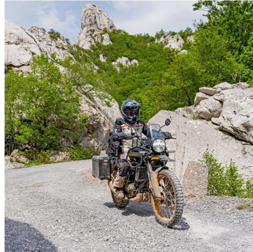
Typische Enduro-Bremse mit weichem Druckpunkt und Bybre-Doppelkolbenschwimmsattel. Der Moderne Einzylinder begeistert mit viel Drehmoment und ist ein genügsames Arbeitstier. Stahlschwinge, knapper Auspuff und Schlauchräder der Dimensionen 21/17-Zoll; gegen Aufpreis gibts auch Schlauchlose Speichenräder.
