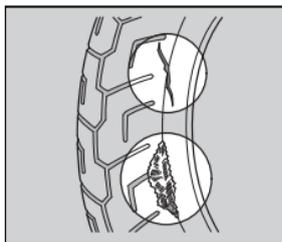
Überprüfen Sie die Reifen auf Einschnitte, Schlitzte oder Risse, die Gewebe oder Kord freilegen, sowie auf Nägel oder andere Fremdkörper in der Reifenwand oder der
