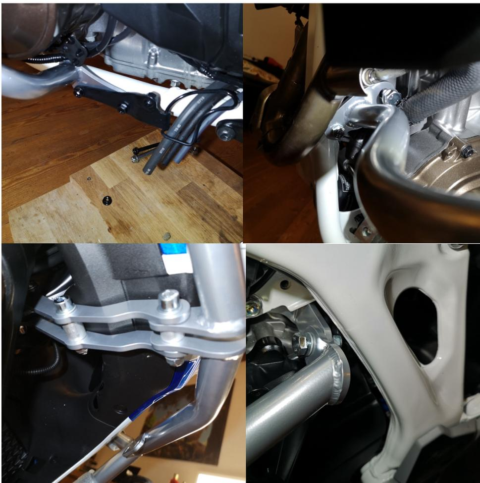
Linken Sturzbügel ansetzen, ggf. mit neuen, längeren Schrauben ...
