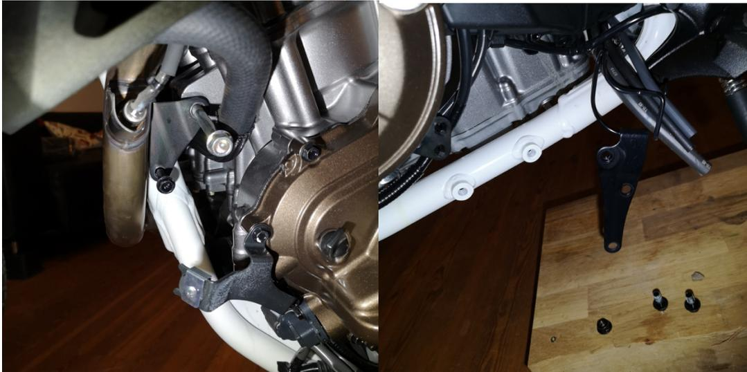
Vorne am Rahmen Schrauben lösen .... Beim Seitenständer BLECH abschrauben.
