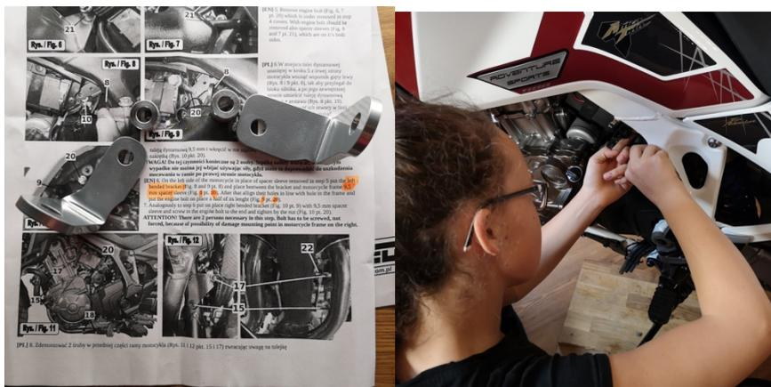
Motorhalterungsbolzen lösen, aufschrauben und herausnehmen.
