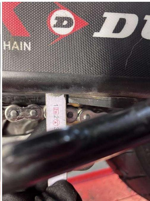
$65 - 16 = 49 \text{ mm}$  Unterhalb Pendelmaß 50-60 geht aber nicht da die Kette oben an der Gleitschine anliegt.
