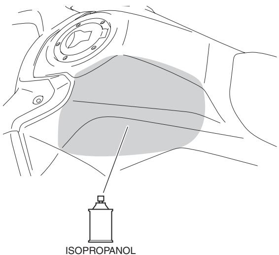
5. Befestigen Sie die Schutzfolie wie in der Abbildung dargestellt am Tank.
