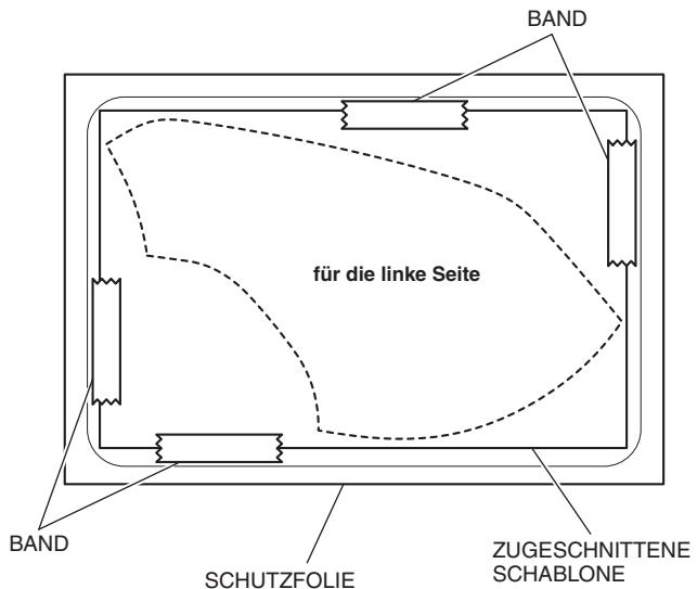
3. Schneiden Sie die Schablone und die Schutzfolie wie in der Abbildung dargestellt zusammen entlang der gepunkteten Linie zurecht.
