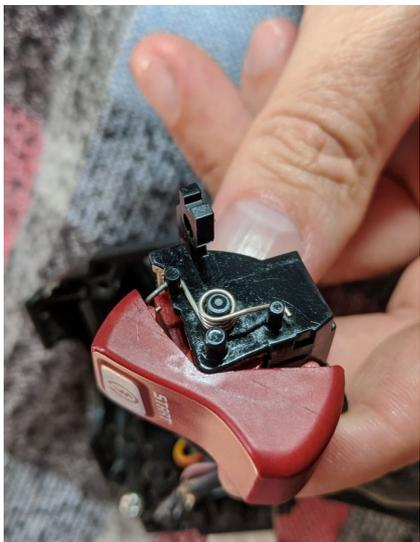
9. Einbaulage der Drehfeder merken, und Drehfeder ausbauen (da sie beim Reinigen leicht verloren geht)
