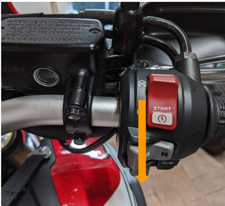
6. Die beiden Schrauben der Kontaktbaugruppe lösen und entfernen:
