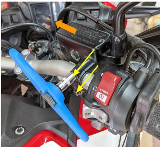
3. Inbusschraube des Handprotectors lösen und entfernen:
