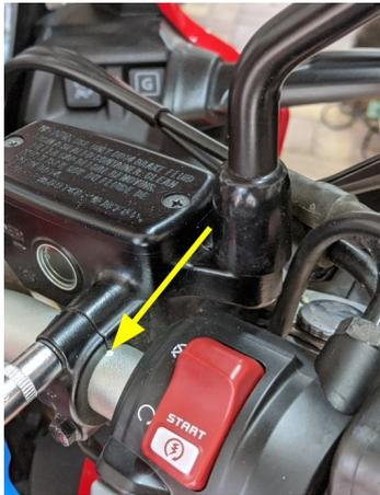
2. Die zwei Schrauben des Bremsflüssigkeitsbehälters etwas lösen, um den Behälter ein paar cm in Richtung Mitte zu verschieben. Damit sind die Schrauben der Schaltereinheit besser erreichbar.
