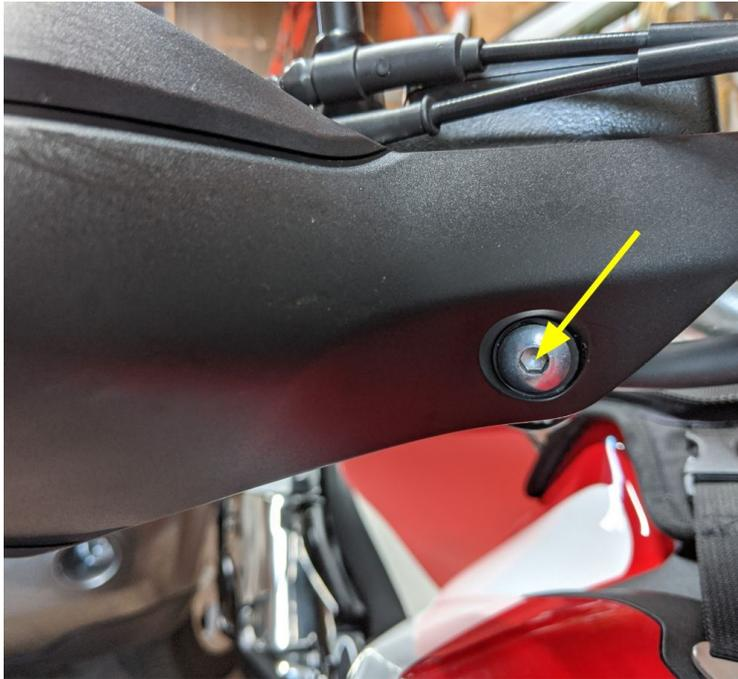
4. Die beiden Kreuzschlitzschrauben der Schaltereinheit lösen und entfernen:
