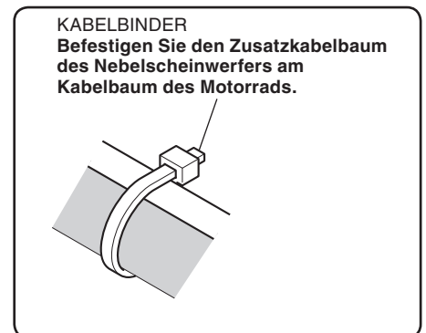
ZUSATZKABELBAUM DES NEBELSCHEINWERFERS
