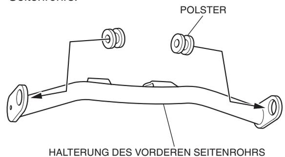
22. Setzen Sie die Flanschmuffen (klein) wie in der Abbildung dargestellt in die Halterung des vorderen Seitenrohrs ein.
