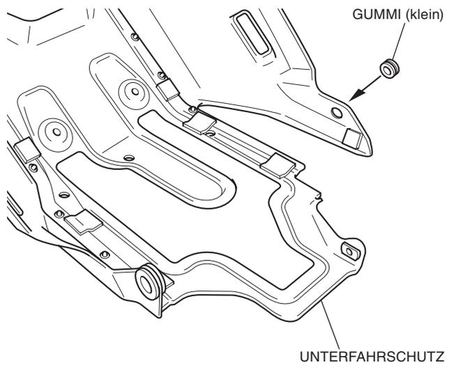
36. Montieren Sie den Unterfahrschutz, wie in der Abbildung dargestellt.
