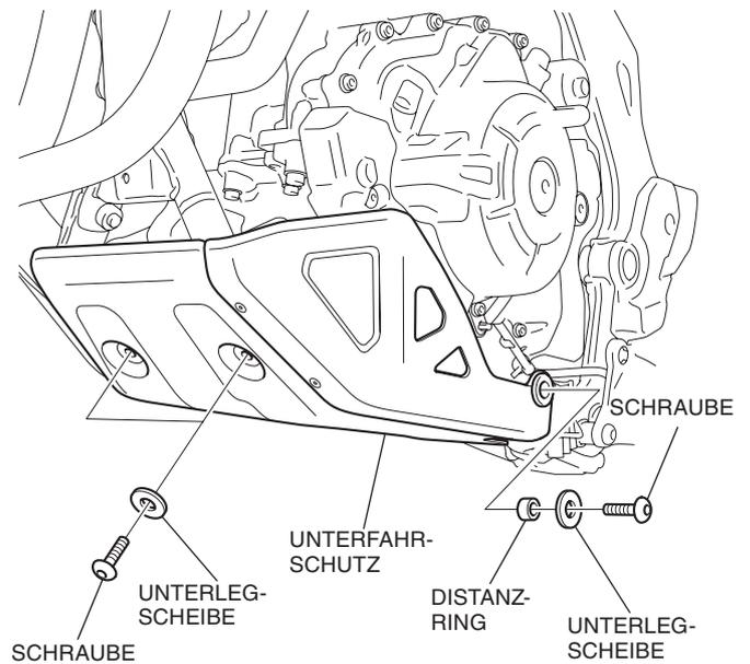
3. Entfernen Sie den Unterfahrerschutz, wie in der Abbildung dargestellt.
