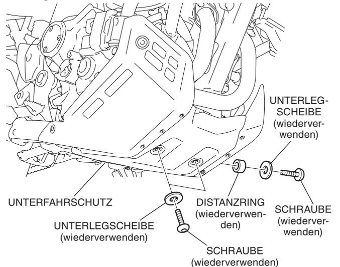
38. Montieren Sie die Teile, wie in der Abbildung dargestellt.
