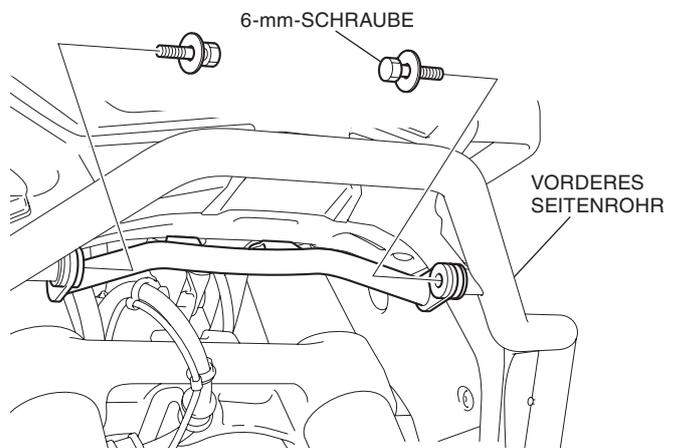
31. Ziehen Sie die 6-mm-Schrauben fest an und befestigen Sie die 6-mm-Schrauben.
