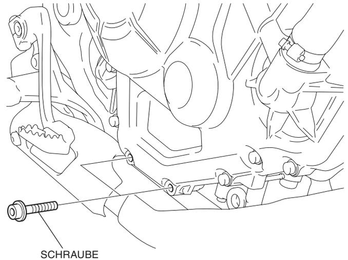
20. Montieren Sie die rechte Unterfahrerschutzstrebe, wie in der Abbildung dargestellt.
