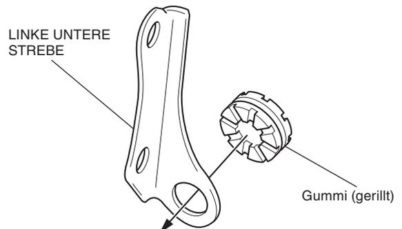
14. Montieren Sie die Flanschmuffe (klein), wie in der Abbildung dargestellt.
