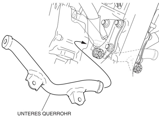
17. Montieren Sie das untere Querrohr, wie in der Abbildung dargestellt.
