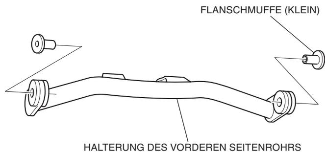
23. Bringen Sie die zusammengebaute Halterung des vorderen Seitenrohrs wie in der Abbildung dargestellt an, ohne sie anzuziehen.
