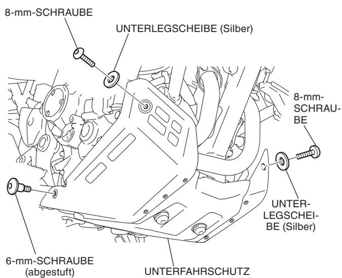
39. Setzen Sie die Teile des Motorrads in der umgekehrten Ausbaureihenfolge ein.
