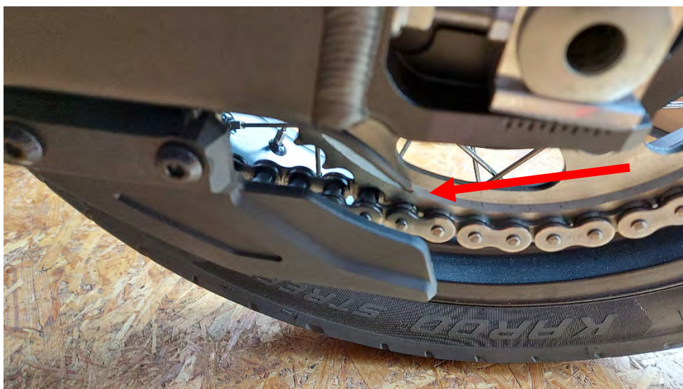
Tropfdüse am Kettenrad bei Stellung 7.00 Uhr
