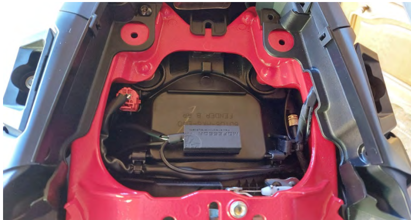
Endmontage Steuergerät, Einstellung Stufe 1
