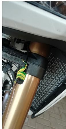
Geschafft! Das Kabel mit dem Zumo XT Ladenippel müsste jetzt unter dem Tank durchgezogen und in Höhe der Gabelbrücke (oben) sichtbar sein.
