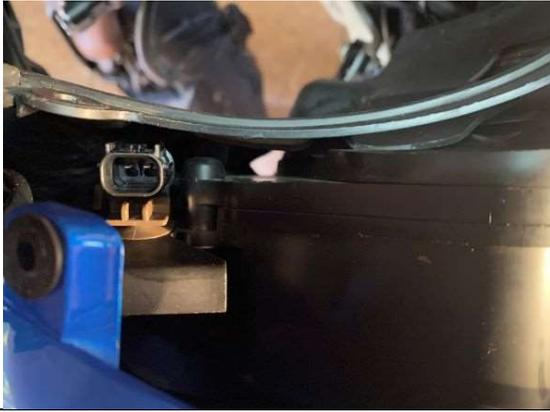
bei mir ist auf dem linken Pin „Plus“ und auf dem rechten Pin „Minus“, sollte bei jedem Model gleich sein vorher selbst messen – schadet bestimmt nicht
