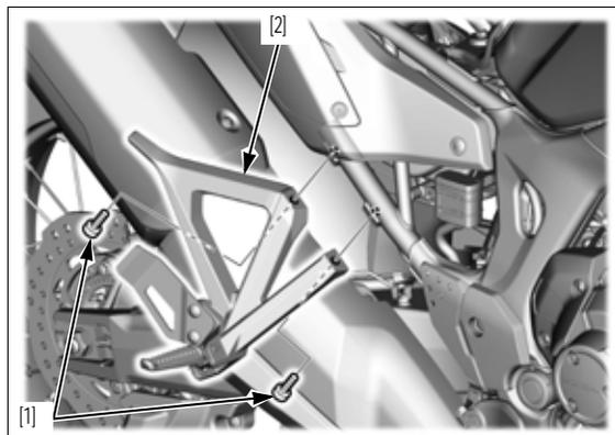
Die Inbusschrauben [1] und die Abdeckung [2] hinten rechts ausbauen.
