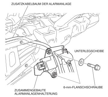
20. Schließen Sie den Zusatzkabelbaum der Alarmanlage wie in der Abbildung dargestellt an das Steuergerät an.
