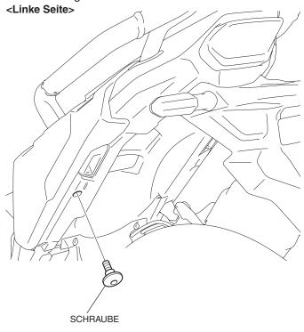
5. Entfernen Sie die linke hintere Seitenverkleidung wie in der Abbildung dargestellt.
