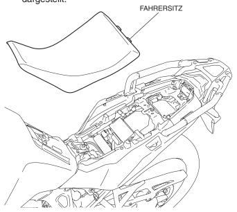
4. Entfernen Sie die Schraube entsprechend der Abbildung.
