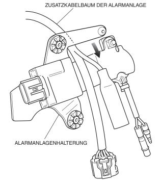
Montieren Sie die zusammengebaute Alarmanlagenhalterung, wie in der Abbildung dargestellt.
