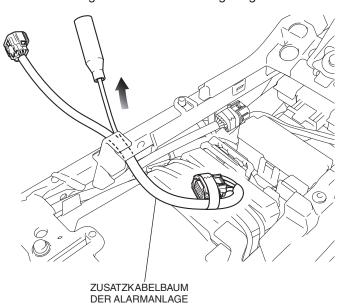
10. Verbinden Sie den Zusatzkabelbaum der Alarmanlage wie in der Abbildung dargestellt.
