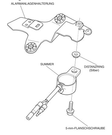
17. Montieren Sie das Steuergerät wie in der Abbildung dargestellt.
