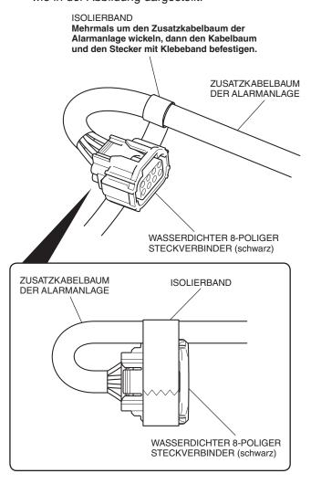
9. Verlegen Sie den Zusatzkabelbaum der Alarmanlage wie in der Abbildung dargestellt.
