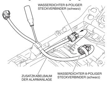
11. Montieren Sie die Tüllen gemäß Abbildung.
