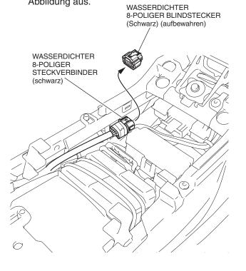
8. Bündeln Sie den Zusatzkabelbaum der Alarmanlage wie in der Abbildung dargestellt.
