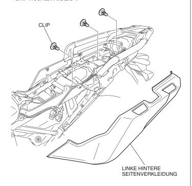
6. Entfernen Sie die Innenabdeckung an der linken Seite wie in der Abbildung dargestellt.
