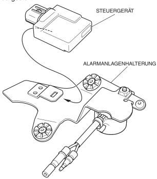
Verlegen Sie den Zusatzkabelbaum der Alarmanlage wie in der Abbildung dargestellt.
