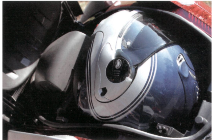
Voluminöser Ansaugkasten frißt die Hälfte des Helm fachs auf
