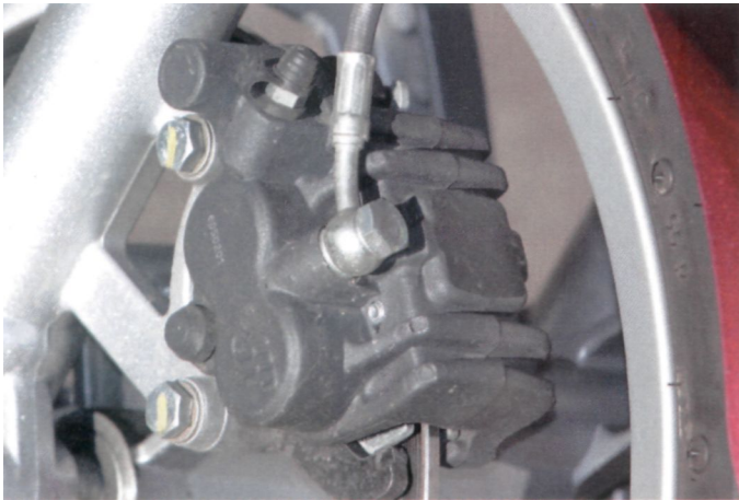
Vordere Doppelkolbenzange erforderte im Test viel Handkraft
