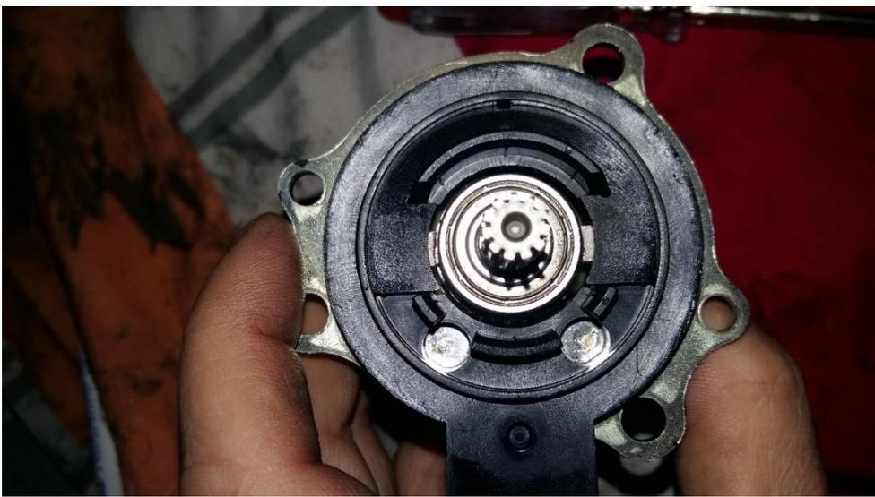
Rotor O-Ring leicht fetten, Deckel und die Gehäuse zusammenschrauben.
