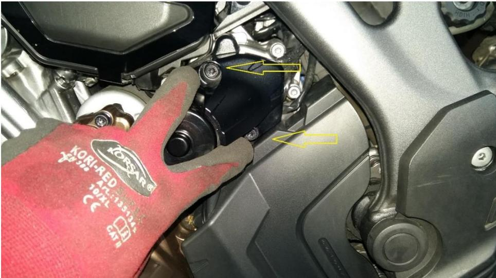
Stecker entriegeln und abziehen. Kabelbaum seitlich schieben.
