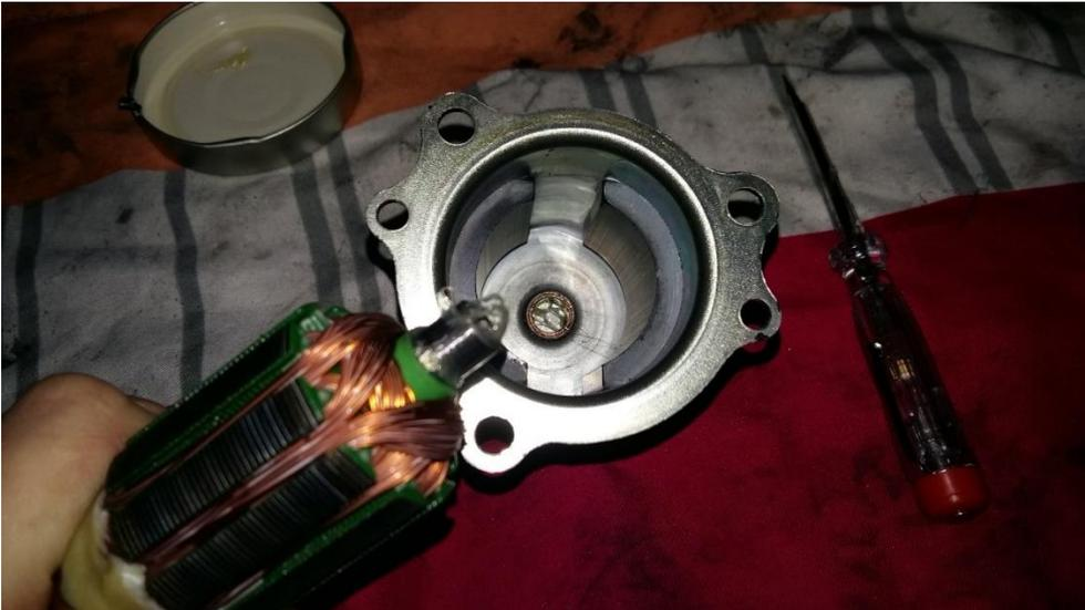
Bürste in der Bürstenhalterung reinstecken und die Halterung vorsichtig an Gehäuse montieren. Achten, dass die Bürste nicht von Kugellager und Kommutator beschädigt werden!
