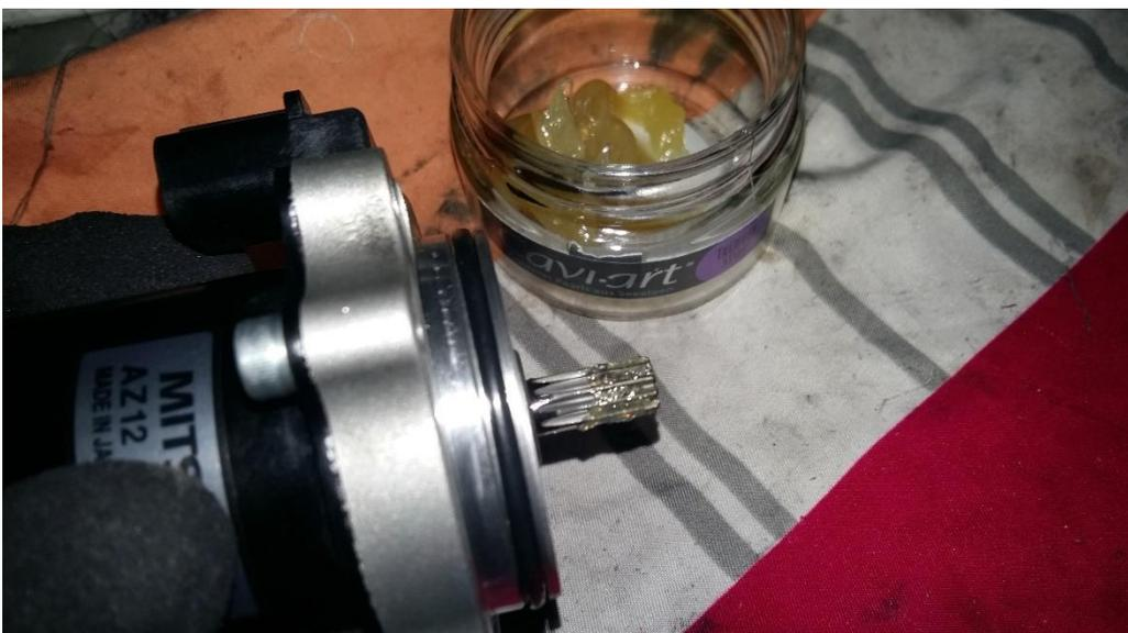
Große O-Ring leicht fetten und den Schaltmotor wieder in Getriebe montieren. 3 Schraube festziehen – Anzugsmoment 14 Nm (Torx T30).
