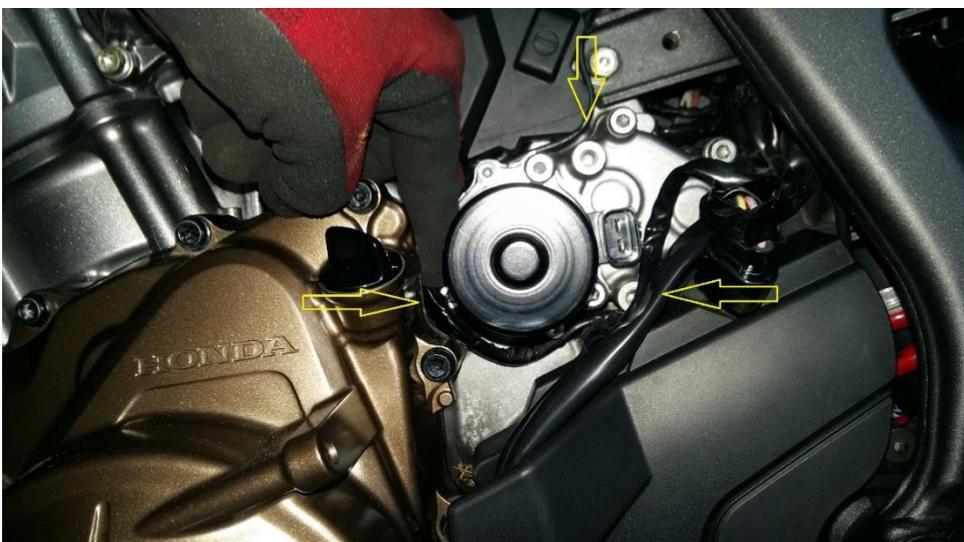
Motor rausziehen. Motor ist mit einem O-Ring gedichtet- nicht beschädigen, gerade ziehen!
