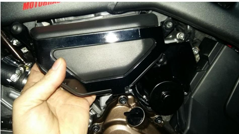
2 Schrauben lösen (Inbus H5). Schutzdeckel abnehmen.
