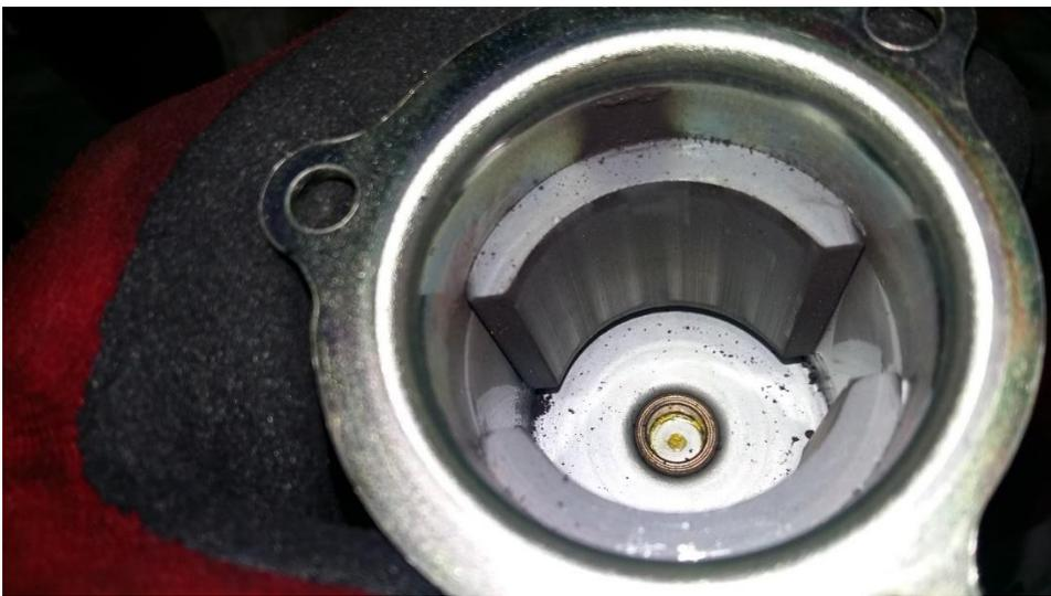
Alles reinigen, prüfen auf Beschädigungen. Kugellager soll ohne klemmen, leicht laufen.
