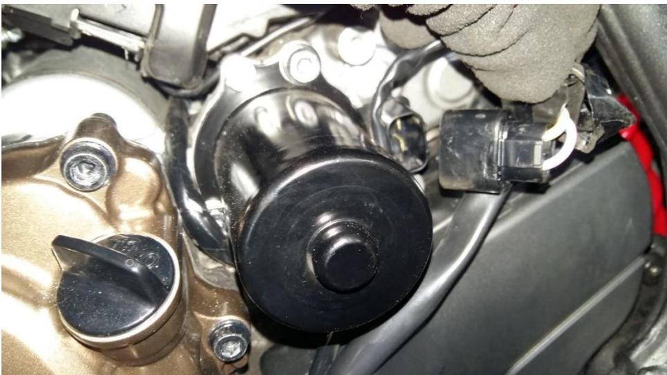
3 Schraube Torx T30 lösen. Die Schrauben sind ziemlich lang, links unten mit Kabel verdeckt- nicht verletzen!
