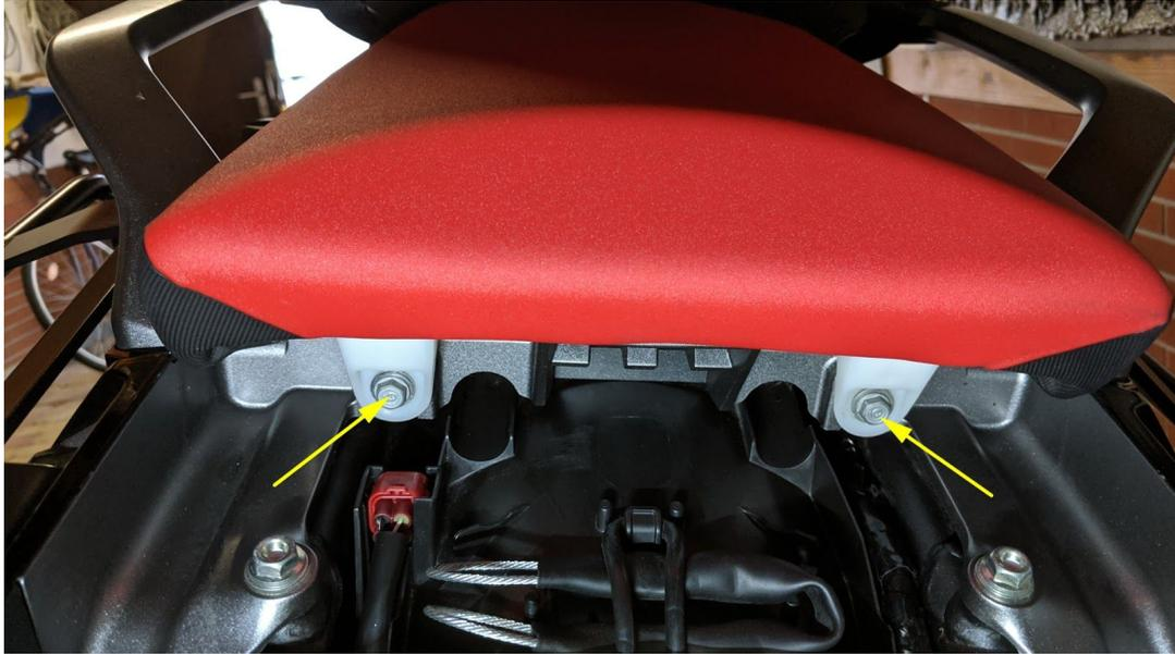
2. Hinteren Zubehör Stecker lokalisieren und abziehen (hinten links in Fahrtrichtung):
