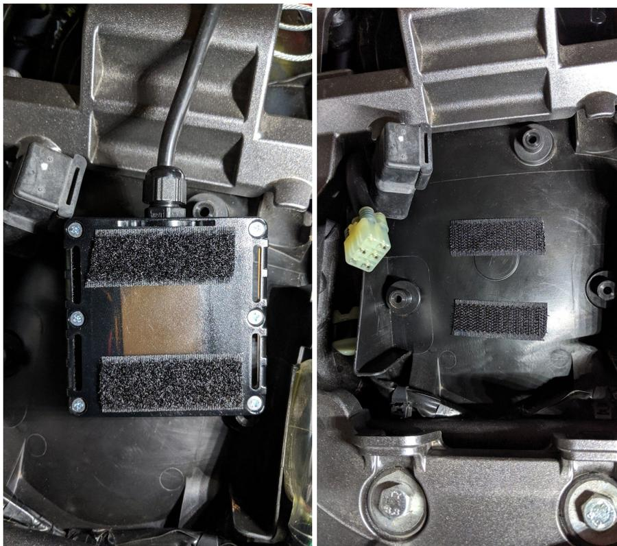
9. Stecker anschließen und GPS Tracker Anschlusskabel verlegen und mit Kabelbinder sichern:
