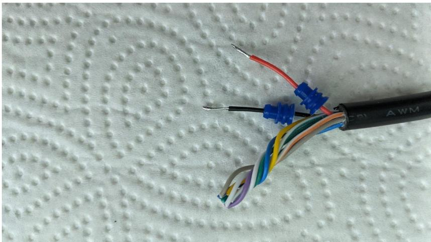
6. Litzen in Steckkontakte einlegen und crimpen:
